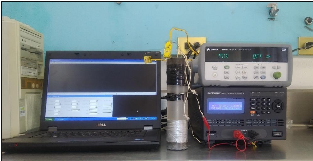
Figura 1. Arreglo experimental para realizar la calibración y mediciones de propiedades termofísicas. En el modo de calibración se utiliza la barra de cuarzo fundido, mientras que en el proceso de medición se utiliza el material que se desea medir.
