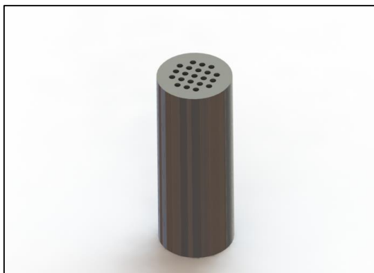
Figura 12. Patrón de orificios 1/4" de diámetro, cabezal de 10 cm.
