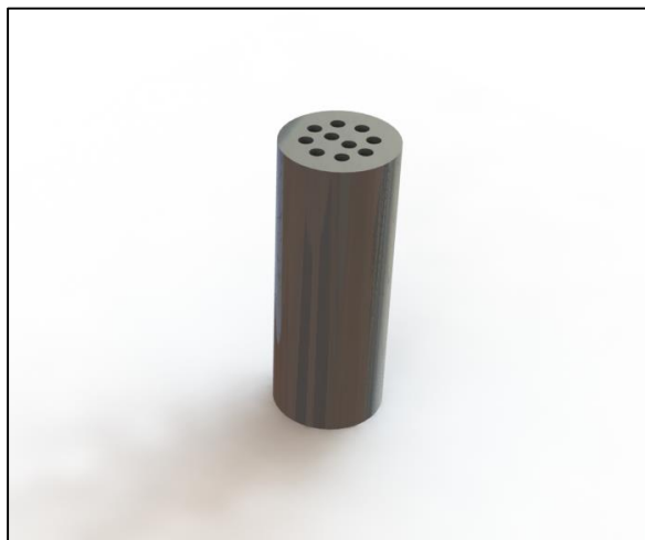
Figura 11. Patrón de orificios 3/16" de diámetro, cabezal de 10 cm.
