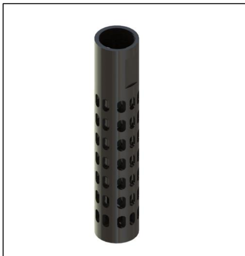
Figura 15. Patrón de orificios 1/4" de diámetro, cabezal base 20 cm.
