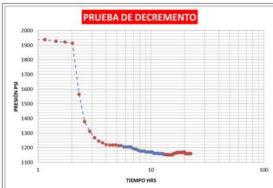
Figura 7. Zona de flujo radial para obtener pendiente. Q=9220 bpd @ 902 m.
