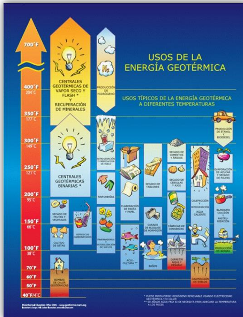
Figura 1. Principales usos de la energía geotérmica como una función de la temperatura (Trillo).
