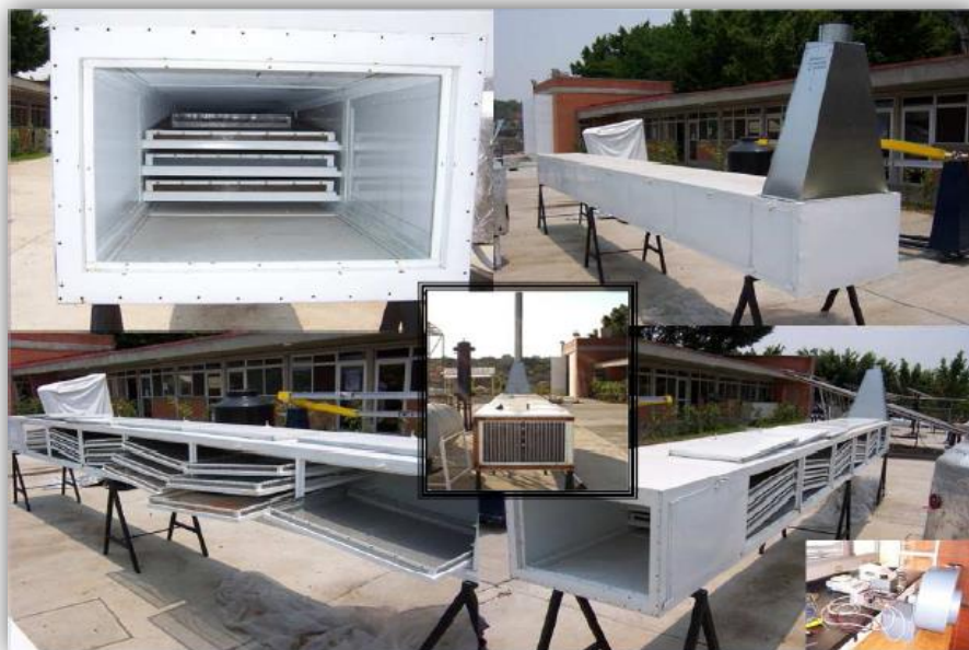
Figura 6. Secador de bandejas que trabaja con energía solar en el IER.
