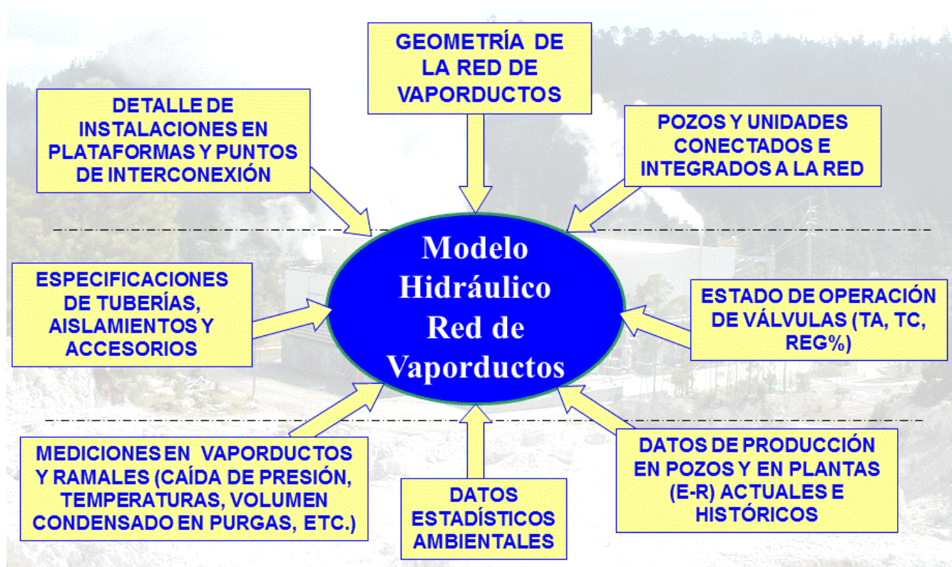
Figura 3. Información típica requerida para un estudio de modelado hidráulico de una red de ductos de vapor geotérmico.
