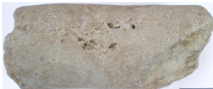
Figura 2. Fragmento del núcleo 4 del pozo H-26, cortado a 2000 m de profundidad, a la izquierda. A la derecha, una micrografía (50 aumentos, luz polarizada) mostrando un fenocristal de plagioclasas inmerso en una masa de cuarzo micro cristalino.
