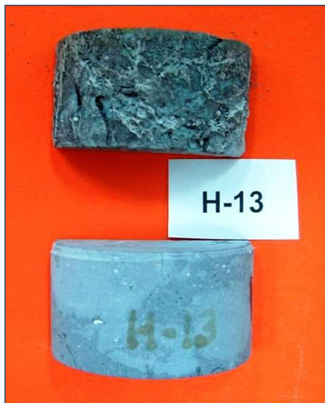
Figura 4. Efecto de la mezcla de HCl y HF en un espécimen del núcleo del pozo H-13 (parte superior). En la parte inferior el espécimen antes de la interacción con la solución ácida.
