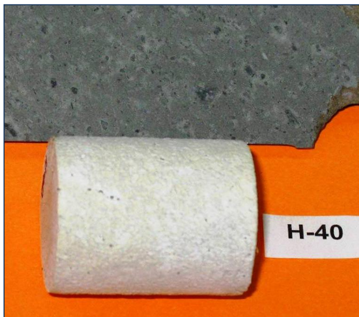
Fig. 5. Especimen del pozo H-40. En la parte superior antes del tratamiento con la mezcla de HCl y HF, y en la inferior después del tratamiento.
