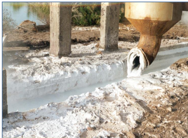
Fig. 1. Incrustación en una descarga de salmuera hacia un silenciador.
