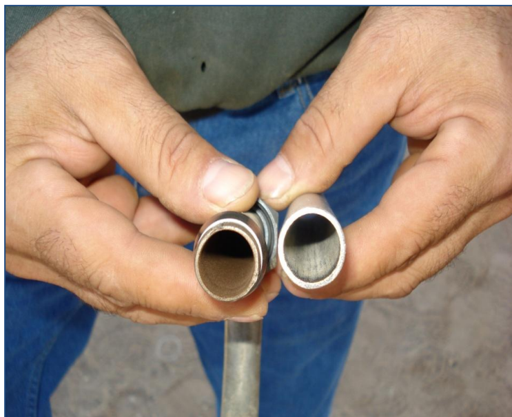
Fig. 6. Vista de una tubería del intercambiador de calor, limpio (izquierda) y después de la primera prueba (derecha).
