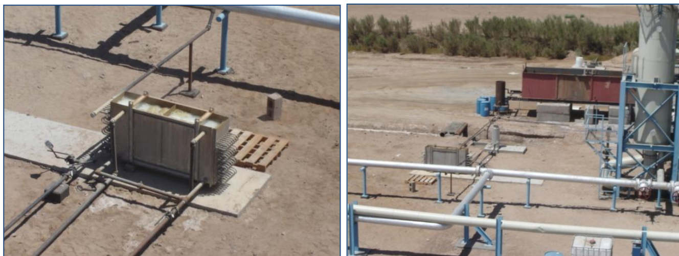
Fig. 5. Vista del intercambiador de calor experimental y del arreglo en plataforma del pozo M-157.
