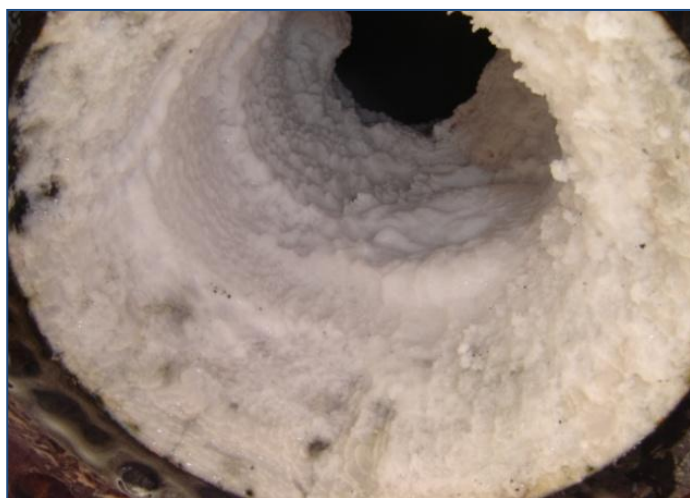
Fig. 4. Incrustación en tuberías del intercambiador de calor de la unidad de 300 kW.
