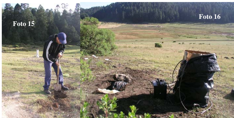
Fotos 15 y 16. Fotos donde se observa la instalación del equipo. Los sismómetros fueron ubicados dentro de excavaciones de aproximadamente 40 a 50 cm de profundidad.
