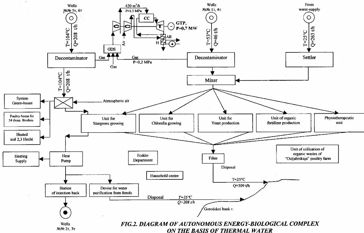
**FIG.2. DIAGRAM OF AUTONOMOUS ENERGY-BIOMASS COMPLEX
