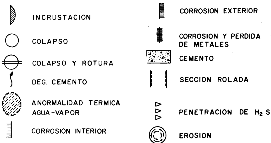
Figura 4. Simbología de los problemas detectados en ademe y cemento.
